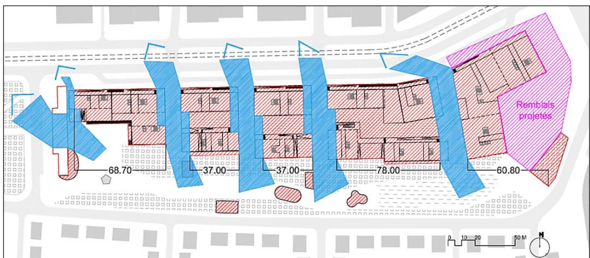
Fig. 54. Largeur des bâtiments situation projetée
