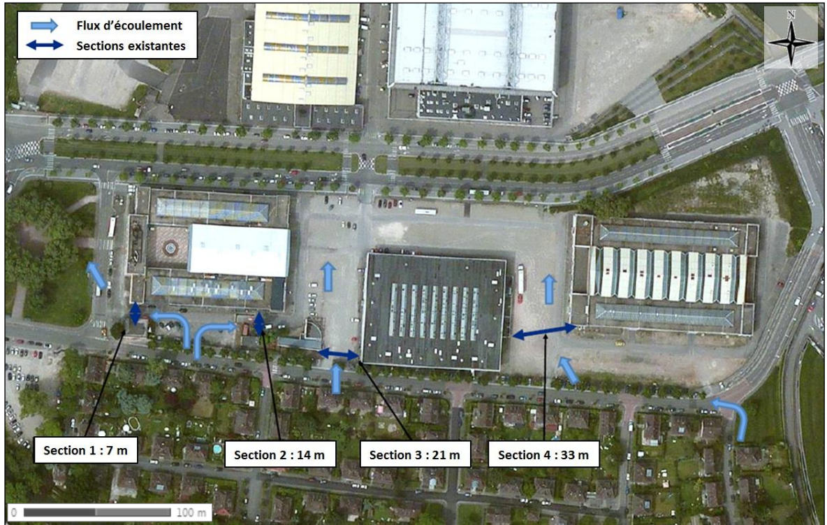
Fig. 51. Sections hydrauliques situation actuelle
