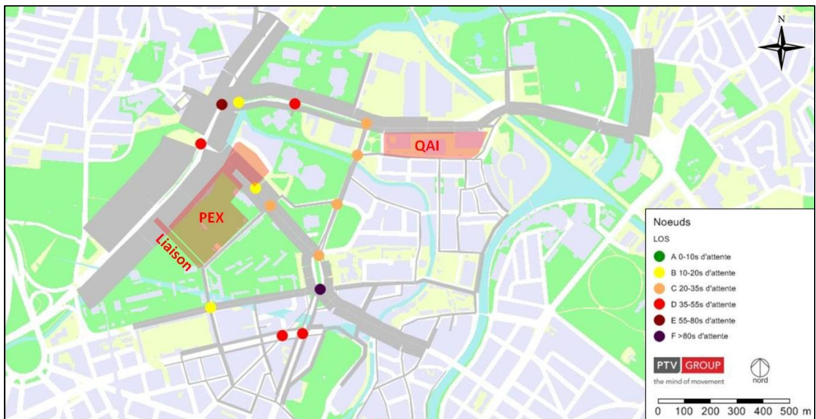
Fig. 99. Temps d'attente moyens aux carrefours, long terme, réseau actuel, flux sortant - HPS
