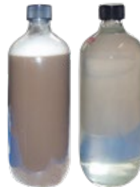
Aspect des eaux usées avant et après prétraitement en séparateur à hydrocarbures
