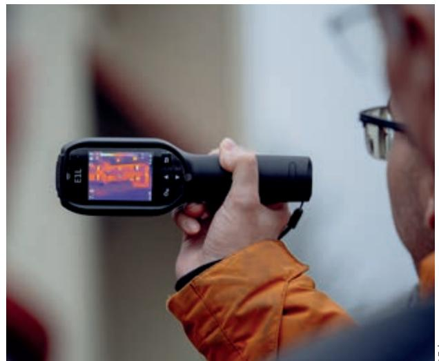
Les caméras thermiques permettent de visualiser les déperditions de chaleur des bâtiments.
