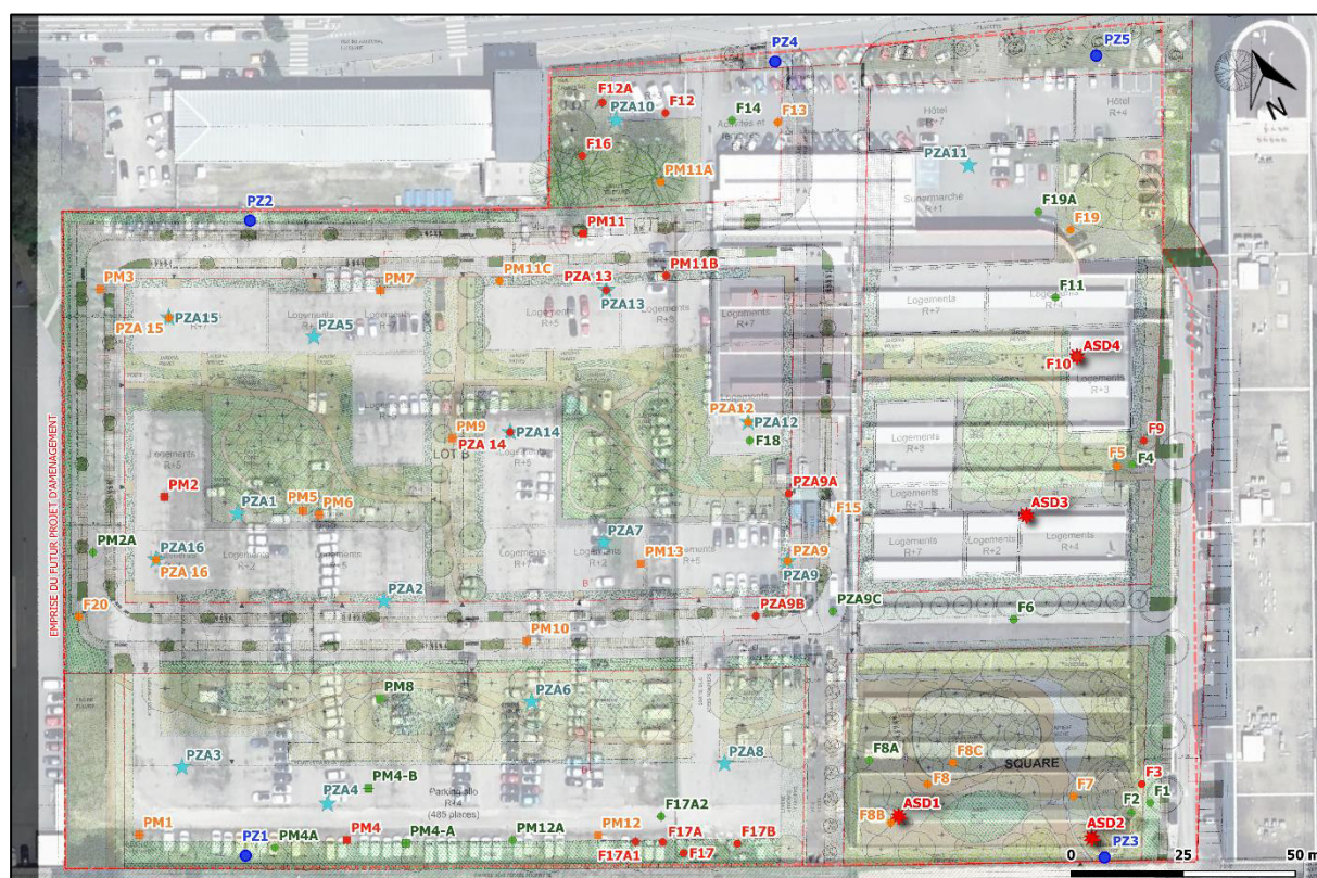
Figure 6 : Localisation des investigations sols, des ouvrages piézométriques et des dispositifs de prélèvement des gaz du sol
