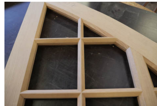
Menuiseries neuves à petits bois pour recevoir un double vitrage, 10 mm, remplissage gaz krypton © Atelier G. André
