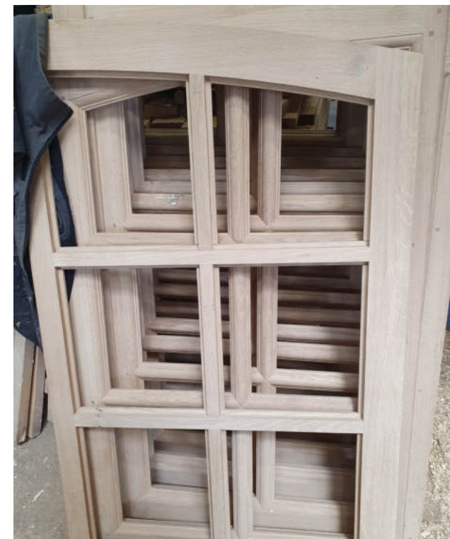
Menuiseries neuves à petits bois pour recevoir un double vitrage, 10 mm, remplissage gaz krypton © Atelier G. André
